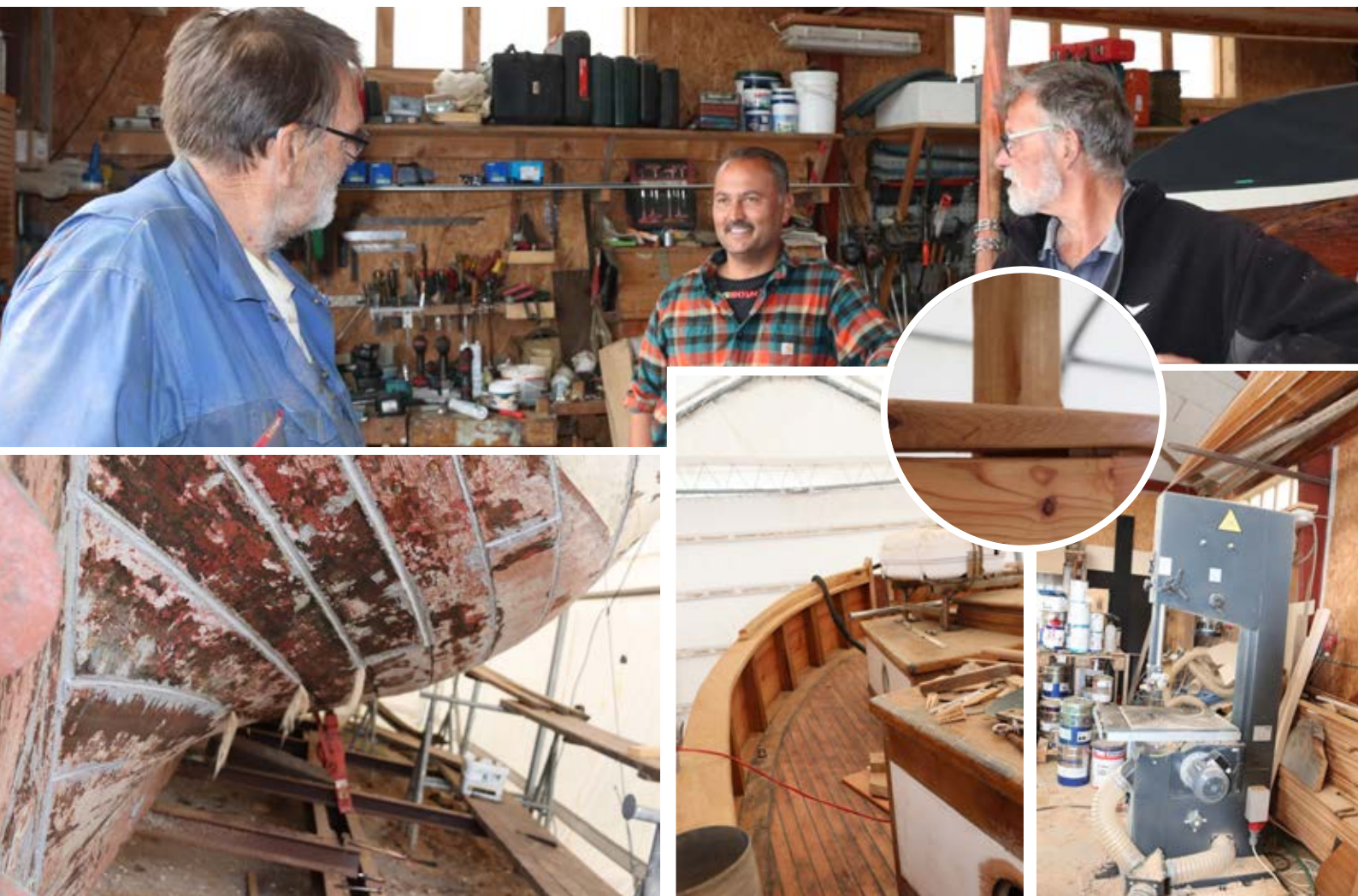
Omkalfatring – den gamle beg og tjære udskiftes.
